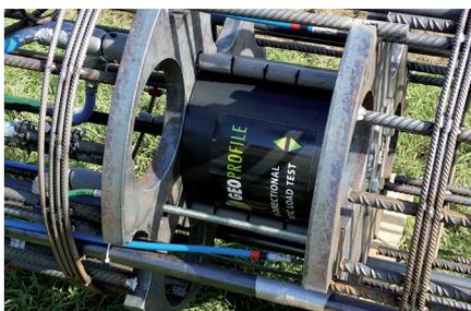
In alternativa, la prova può essere eseguita in modo bidirezionale. Le caratteristiche essenziali di un'esecuzione bidirezionale sono la misurazione separata e indipendente della resistenza alla punta e dell'attrito della guaina lungo il fusto del palo. Nel palo da testare viene infatti installata una cella di carico (O-Cell) ad alta capacità e non è quindi necessaria una struttura di contrasto esterna.
